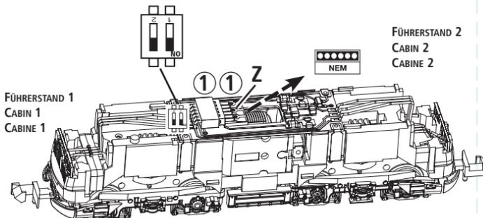
**Hinweis:** Die Stirnbeleuchtung der Lok kann mit Hilfe der DIP-Schalter S1 (für FS2) oder S2 (für FS1) auf der Platine für jede Lokseite abgeschaltet werden.
