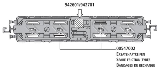
**Reinigen der Lokräder:** Bei Verschmutzung sind die Laufflächen der Räder mit sauberem Lappen oder Schienenreinigungsgummi 6595 zu reinigen. Niemals die angetriebenen Räder von Hand drehen, sondern durch Anlegen einer Fahrspannung mittels Anschlussdrähten antreiben. Nichtangetriebene Räder können von Hand gedreht werden.
